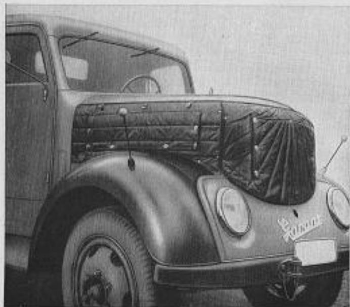
Bild 46 Befestigung der Kühlerschutzhaube
