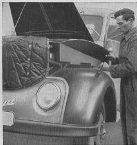
Bild 69 Deckblech für linken Vorderkotflügel bei zusätzlicher Warmluftabführung
