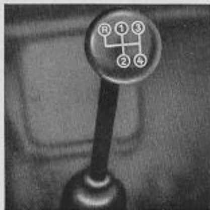
Bild 64. Schalthebelkopf mit Schallanordnung
