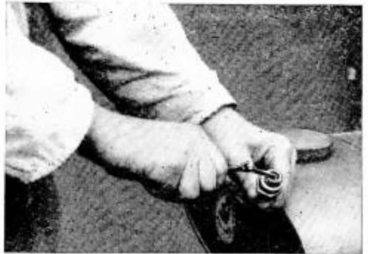
Bild 27: Prüfung des Elektroden- abstandes der Zündkerze.
